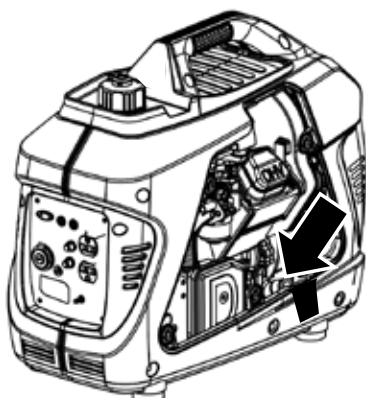
Figura 2: Tapón de llenado / drenaje de aceite
