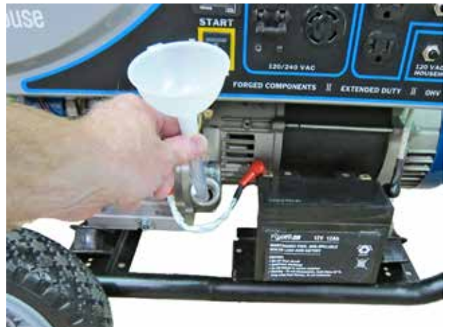
Figura 28 – Procedimiento para agregar el aceite del motor
