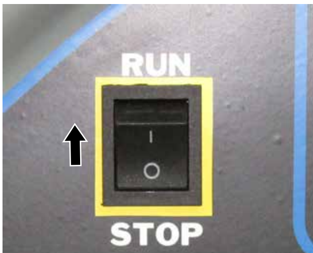
Figura 19 – Interruptor de control del motor
