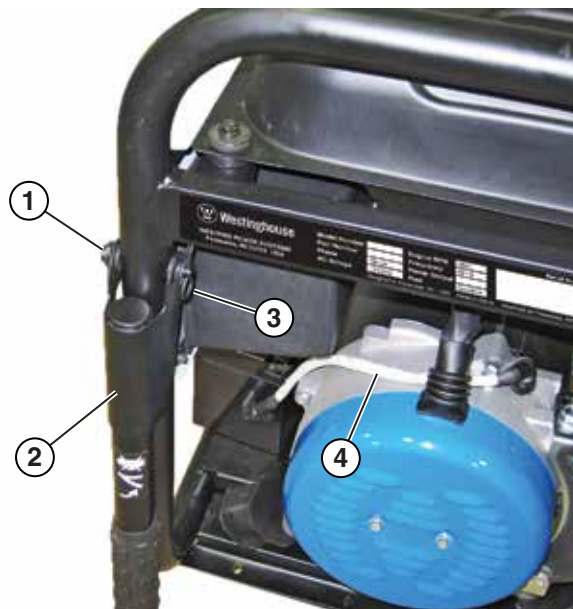
Figura 7 – Colocación de las manijas
