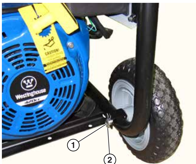
Figura 6 – Ensamble las ruedas al bastidor
