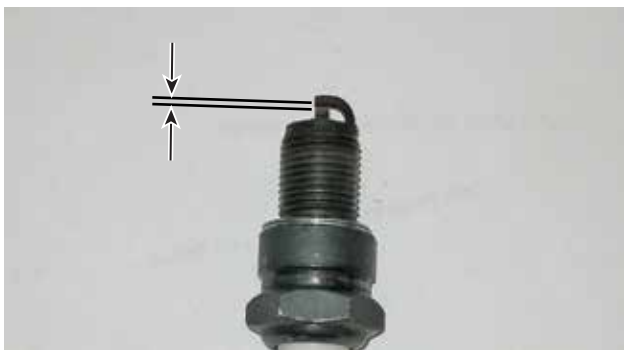
Figura 38 – Requisitos de separación de la bujía
