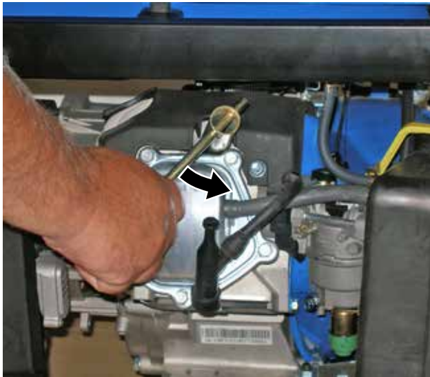
Figura 37 – Procedimiento para extraer la bujía
