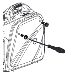
Figura 2-7. Retiro de la cubierta lateral
