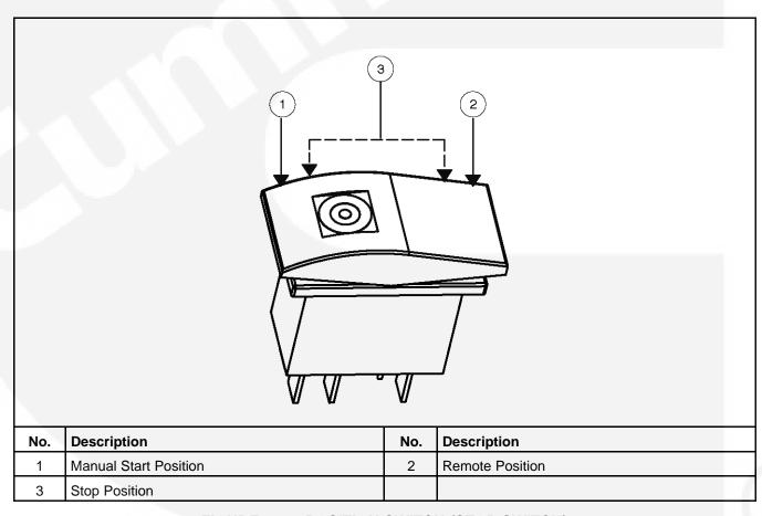
FIGURE 2. 3 POSITION SWITCH (STOP SWITCH)
