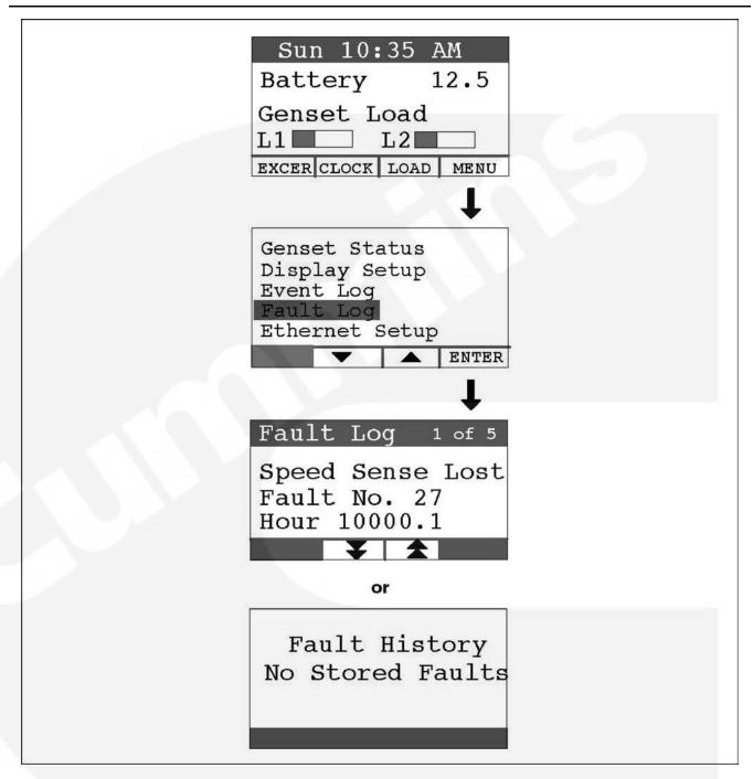
FIGURE 21. FAULT LOG SCREEN
