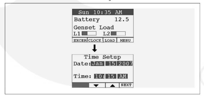
FIGURE 16. TIME SETUP SCREEN
