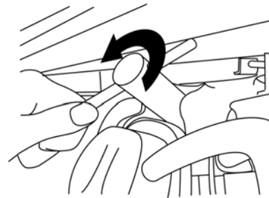
FIGURA 33: Retiro de la bujía
