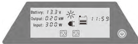
Figura 11 Carga simultánea y modo de salida con salida de corriente alterna Dependiendo de las tomas que se utilicen, se iluminarán los indicadores relacionados:
